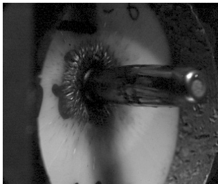
Beschusstest* von Al_2O_3 -Keramik vor Aluminium-Backing.
